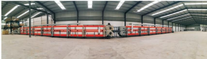
无机复合不燃保温板连续化链板生产线
